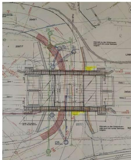
Durch den Neubau wird die bestehende ÖBB-Unterführung Vordergrub in Ihrer Breite und Höhe erweitert. Mit einer **neuen Durchfahrtshöhe von ca. 4,25m** und einer **neuen Durchfahrtbreite von 5,20m** werden nach Fertigstellung alle gängigen Fahrzeuge die Unterführungen passieren können. Sonderfahrten über den Römerweg sind somit Geschichte.
